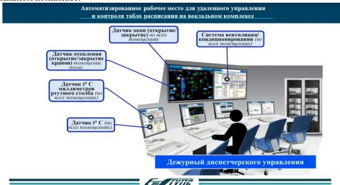
Рисунок 1 – Автоматизированное рабочее место для удаленного управления и контроля табло расписания на вокзальном комплексе
