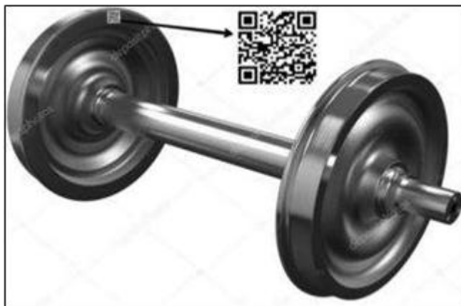
Рисунок 1 – Использование QR-кода, RFID-метки или DataMatrix для маркировки колёсной пары вагона
