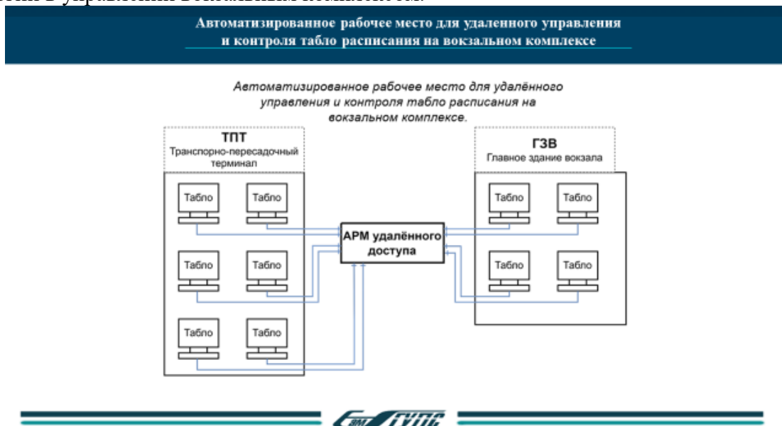
Рисунок 2 – Автоматизированное рабочее место для удаленного управления и контроля табло расписания на вокзальном комплексе
